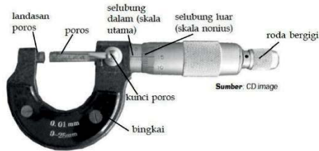
Gambar 1.6 Mikrometer sekrup dan bagian-bagian utamanya
