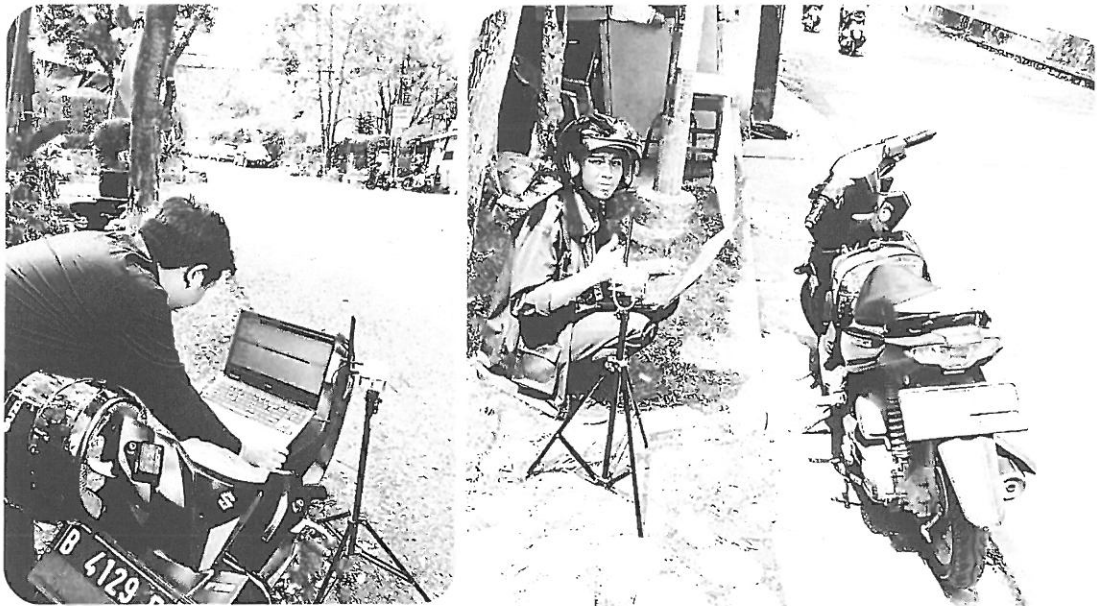
Gambar 12. Pengukuran Tx dan Rx LoRa dari berbagai titik
