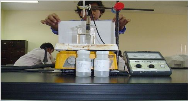
Gambar 1.7. Set alat titrasi potensiometri
