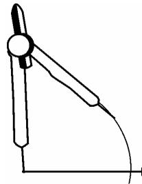
4. Buka jangka untuk mengukur bukaan sudut yang diketahui
