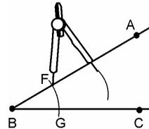
4. Dengan pusat G, dan bukaan yang sama dengan langkah 3, buat busur sehingga memotong busur yang dibuat pada langkah 3.
