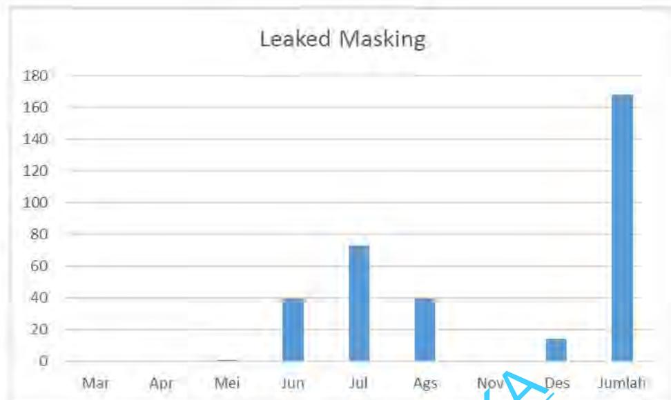
Bagan 4.7 Data *Defect Leaked Masking* Komponen *Threaded Ring* D59502 Per Bulan Sepanjang Tahun 2010
